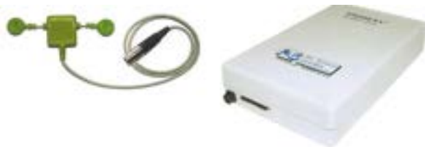
Afb. 16: Ambulante automatische elektrofysiologische slaapanalysator ter registratie en automatische indeling van de stadia en kwaliteit van de slaap d.m.v. een driepuntselektrode op het voorhoofd en toepassing van neuronale meettechniek
